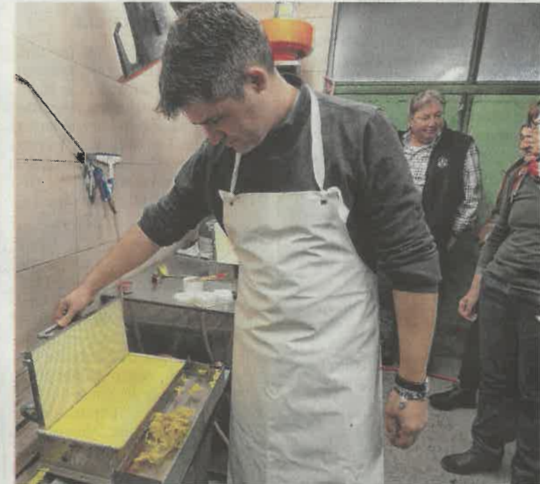
Michael Kraus öffnet die Gussform und begutachtet die fertige Mittelwand, während Wolfgang Fritz im Hintergrund „fachsimpelt“.
